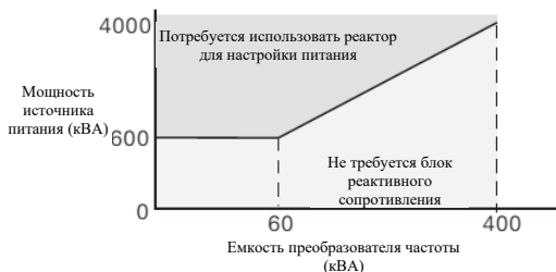
Рис. 4-4 Условия монтажа реактора
