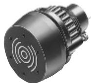
Для выступающего монтажа - Ø22,5 мм, 24VDC, IP65, 2,8 kHz, 95 dB на расстоянии 0,1 м, клеммы под пайку / fast-on 2,8x0,5 мм
