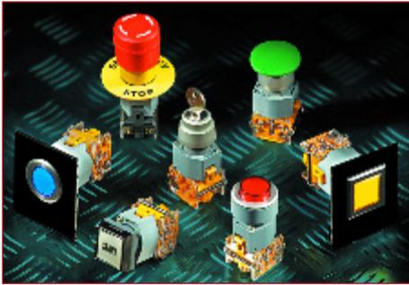
**Кнопки серии 04, для скрытого монтажа (заподлицо), типоразмер Ø30 мм и 30x30 мм, подключение — винт или клеммы типа Fast-on 2,8x0,8/ 6,3x0,8 мм. Доступны также антивандальные исполнения.**
