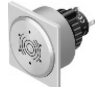
Для скрытого монтажа - Ø30,5 мм, 24VDC, IP40, 2,8 kHz, 95 dB на расстоянии 0,1 м, клеммы под пайку / fast-on 2,8x0,5 мм
