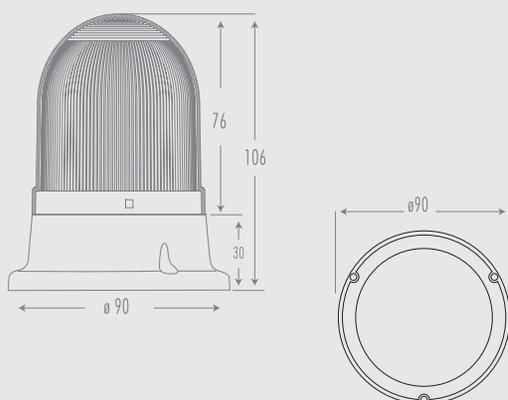
SNT-70 Сигнальный Маячок с  $\varnothing 22$  Гайкой
