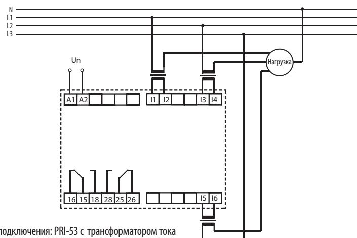
Пример подключения: PRI-53 с трансформатором тока для увеличения диапазона контролируемого уровня тока
