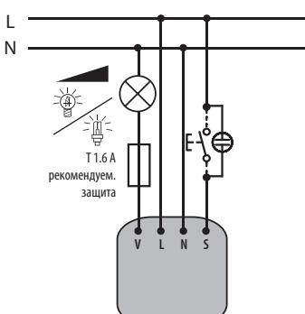
\* Из-за большого количества типов световых источников, макс. нагрузка зависит от внутренней конструкции регулируемых LED и КЛЛ ламп и их эффект  $\cos \phi$ .
