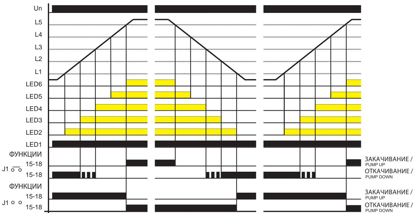
Устройство предназначено для контроля за уровнем токопроводящей жидкости в баках при помощи шести простых зондов или одного шестикратного зонда С. В случае использования токопроводящего бака возможно использовать бак вместо одного совместного зонда С.
