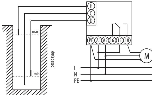
Контроль ДВУХ УРОВНЕЙ мин. / макс. – функция ОТКАЧИВАНИЯ – (PUMP DOWN)
