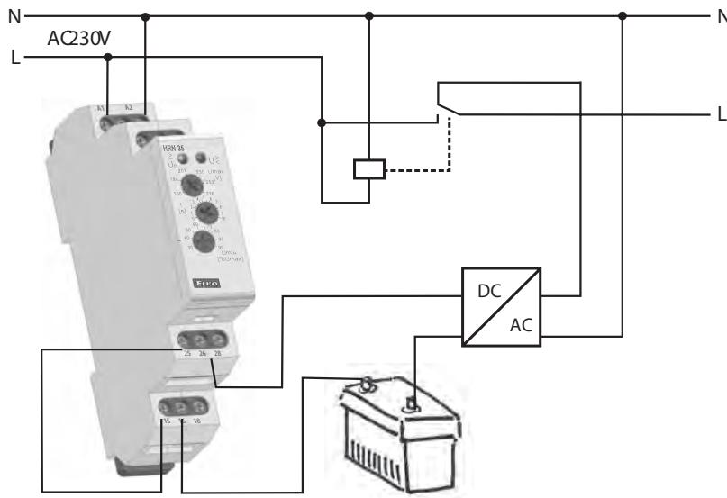
**Реле контроля напряжения HRN-34**
