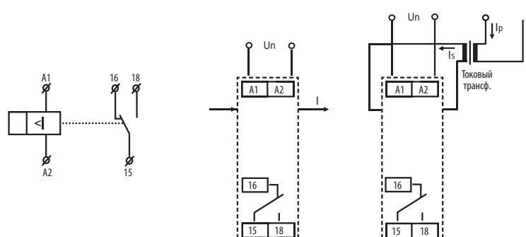
Пример подключения: PRI-52 с токовым переводным трансформатором для повышения токового диапазона.
