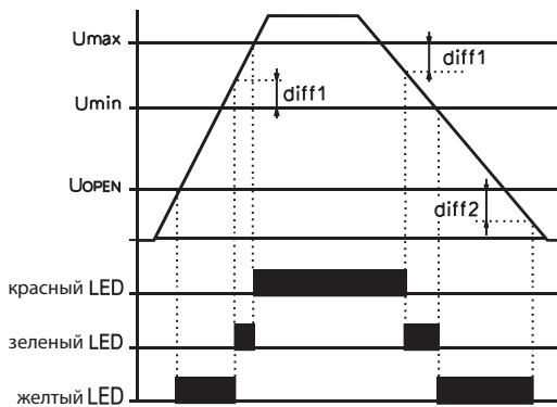
При подключении питания загораются LED диоды - их цвет соответствует величине напряжения на отдельных фазах. Если фазовое напряжение упадет ниже 40V (выпадение фазы), соответствующий LED погаснет.
