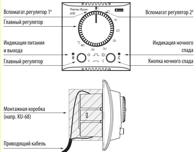
\*- вспомогательные регуляторы 1 и 2 доступны после снятия главного регулятора
