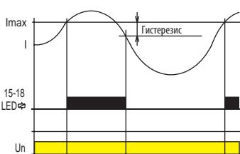
Реле контроля PRI-32 предназначено для контроля уровня токов в однофазных AC цепях. Плавная настройка подаваемого тока позволяет использовать реле в аппликациях с необходимостью индикации проходящего тока, используется также как реле выбора. Выходное реле в нормальном состоянии разомкнуто. При превышении настроенного уровня силы тока реле замкнется. Выгодой в данном случае является универсальное напряжение питания.
