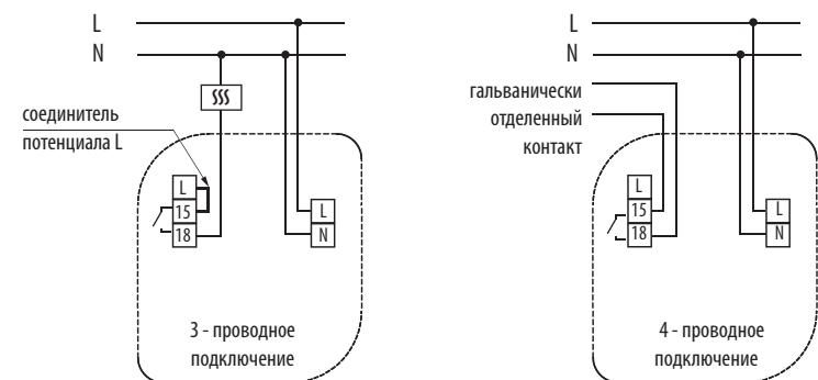
Устройство поставляется с соединителем L-15 (3-проводное подключение). Для правильного функционирования устройства необходима установка сенсором вниз.
