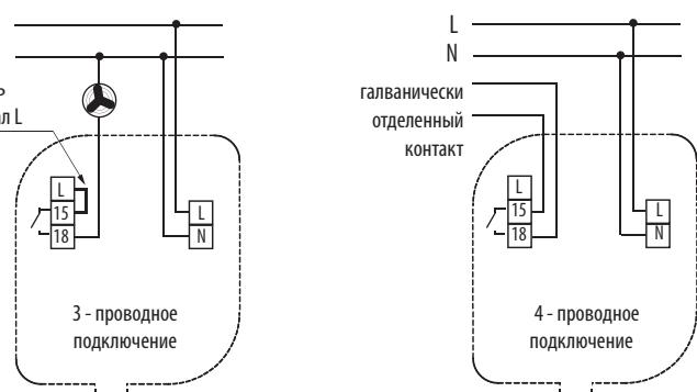
Устройство поставляется с соединителем L-15 (3-проводное подключение). Для правильной функции устройства, необходима установка датчиком вниз.
