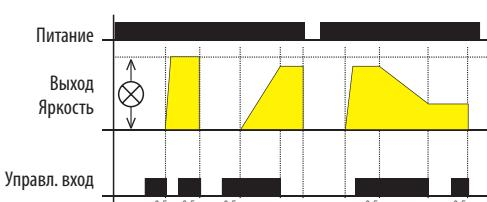
Кратким нажатием(<0.5 c) светильник включается, последующим кратким нажатием -выключается. При длительном нажатии (> 0.5 c) происходит плавная настройка яркости.
