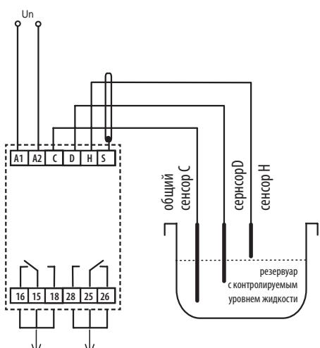
Выходное реле для управления насосом или другим контролируемым оборудованием, выбор контактов зависит от выбранной функции
