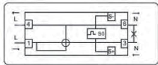
Измеритель потребления энергии на DIN-рейку оборудован импульсным выходом. Для тестирования выходного импульса подключите напряжение 5 VDC к коннектору S+ (анод) и сигнальную нагрузку (S) к коннектору S- (катод).
