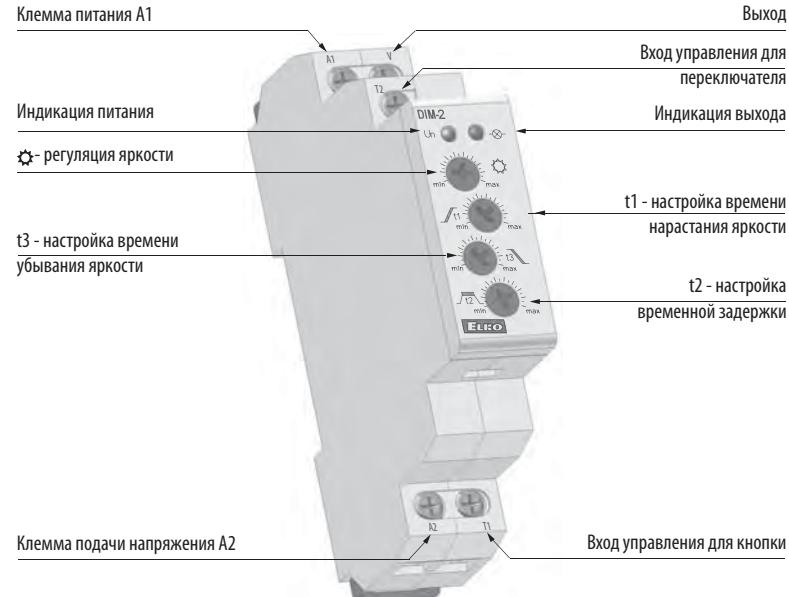
Рекомендации при установке: с каждой стороны устройства необходимо оставить пространство мин. 0.5 ширины модуля, т.е. 9 мм для лучшего охлаждения.
