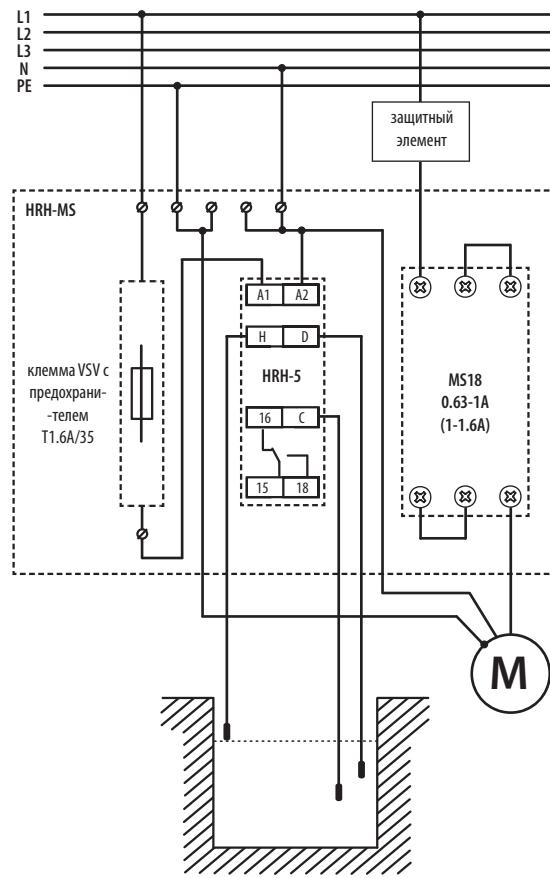
Комплекс контроля уровня жидкости HRH-MS-VS-2.5A (HRH-MS-VS-4A, HRH-MS-VS-6.3A):
