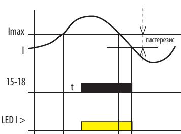
Реле PRI-52 служит для контроля силы тока в монофазовых AC цепях. Плавная настройка обеспечивающего тока предназначает реле для многих и разных электроинсталляций. Реле выхода в нормальном состоянии выключено. При превышении заданного уровня тока реле после настроенной задержки замкнет. При возвращении из состояния ошибки в нормальное состояние проявляется гистерезис.
