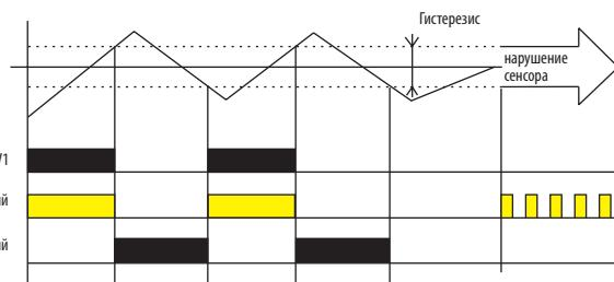
TEV-2 и TEV-3 универсальный одноуровневый термостат для обычного использования. Если температура окружающей среды выше, чем настроенная, для функции охлаждения (обратная функция) можно применить размыкающий контакт (V2).
