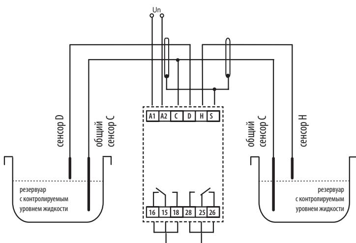
Управление насосом или другим контролируемым устройством
