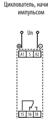
Циклователь, начин. импульсом Циклователь, начин. паузой (пропойка S-A1)
