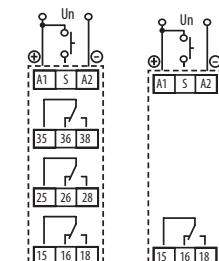
Между клеммами S-A2 возможно подключить нагрузку (например контактор, контроллер или др.) без нарушения функции реле (нагрузка под напряжением пока кнопка нажата.).
