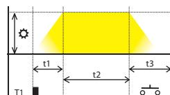
Нажатием кнопки начнется цикл **нарастание - свечение - убывание**. Возможно продление времени цикла повторным нажатием кнопки (во время цикла).
