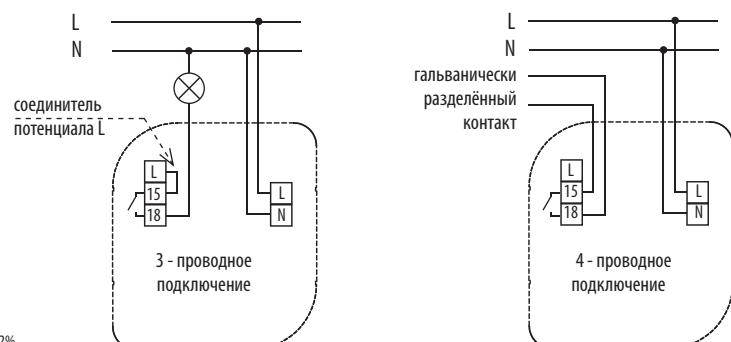
Устройство поставляется с соединителем L-15 (3-проводное подключение). Для правильной функции устройства необходима установка сенсором вниз или в стороны.
