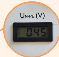
→ Отключение при напряжении  $45 \pm 5$  V на нейтральном проводнике
