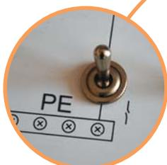
→ Отключение при обрыве заземляющего проводника
