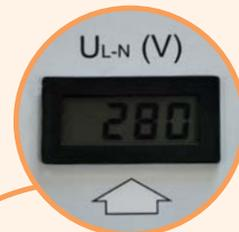
→ Отключение при повышении напряжения до  $270 \pm 10$  V
