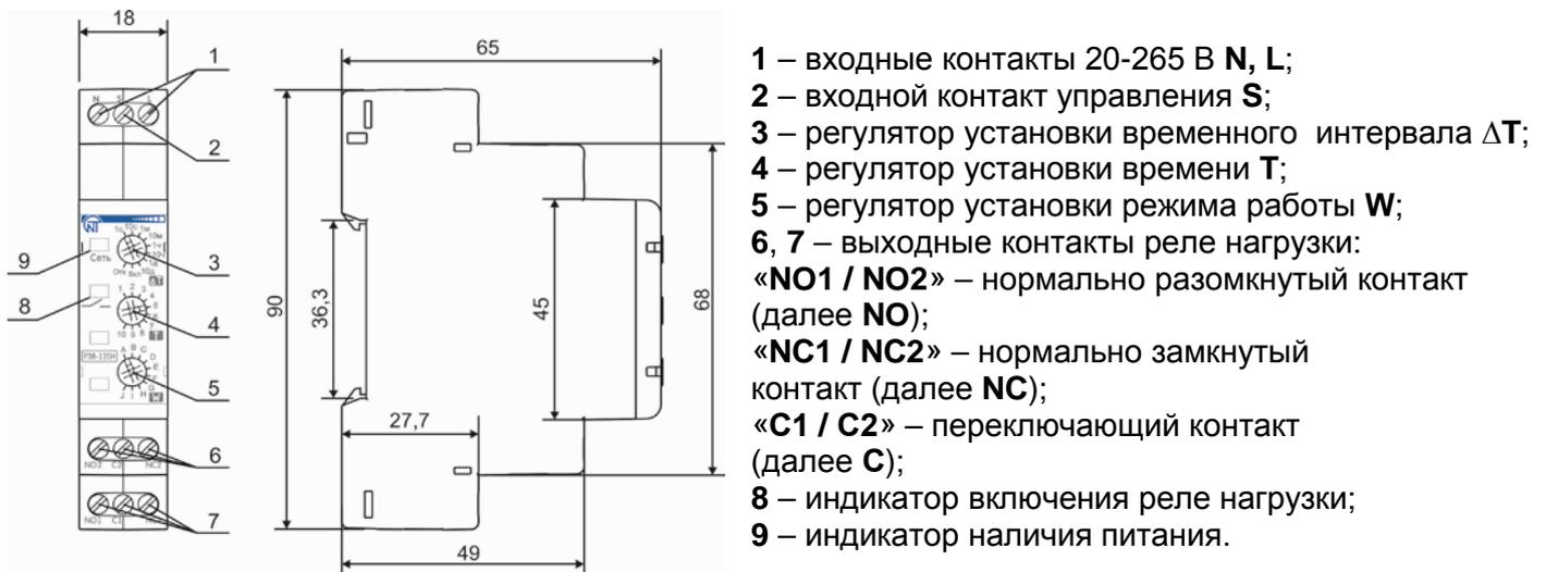
Рисунок 1 – Органы управления, габаритные и установочные размеры РЭВ-120Н
