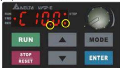
5. При изменении режима на «PLC2», интерфейс RS485 будет использоваться для работы с контроллером.
