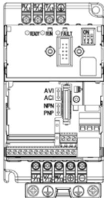
Силовые терминалы: R/L1, S/L2, T/L3, U/T1, V/T2, W/T3,  $\ominus$ , +, -
