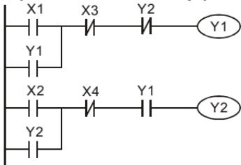
Выход Y2 может быть включен, только если включен Y1, однако при включении Y2 выход Y1 будет отключен.
