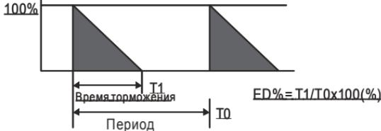
Величина цикла торможения ED% определяет минимальный период торможения, при котором произойдет полное рассеяние тепла на тормозных модулях и резисторах, выделенное за
