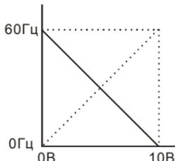
Pr.01.00=60Гц--Макс. вых. частота
