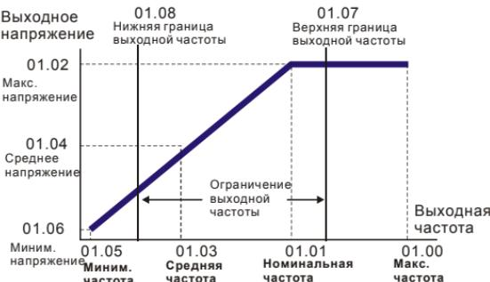
**Типовая зависимость V/f**
