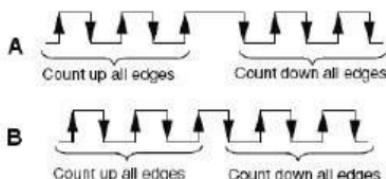
2. Импульсы + сигнал направления (D1044 = 1): по входу A идут счетные импульсы, а по B сигнал, определяющий направления счета (инкрементирование или декрементирование). Датчик импульсов должен быть подключен к клеммам  $\bar{A}$ ,  $\bar{B}$  и GND.
