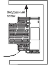
Установка VFD-E-P с подключением его к внешней системе вентиляции.
