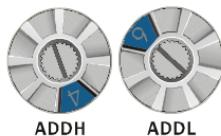
Адрес модуля CME-PB01 в сети PROFIBUS устанавливается двумя поворотными переключателями ADDH и ADDL, в шестнадцатеричном (HEX) формате. ADDH устанавливает старшие 4 бита, а ADDL - 4 младшие бита адреса PROFIBUS.
