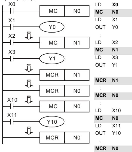
Область программы между инструкциями MC N0 и MCR N0 будет выполняться только если X0=1. Область программы между инструкциями MC N1 и MCR N1 будет выполняться только если X0=1 и X2=1
