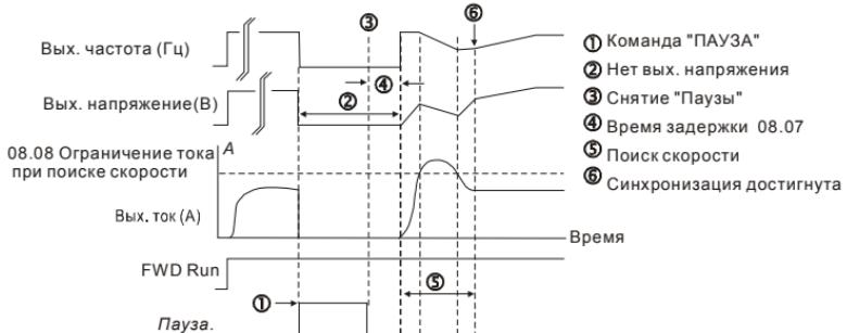
Рис 1:Поиск скорости с последнего заданного значения частоты (с ограничением тока при поиске скорости)
