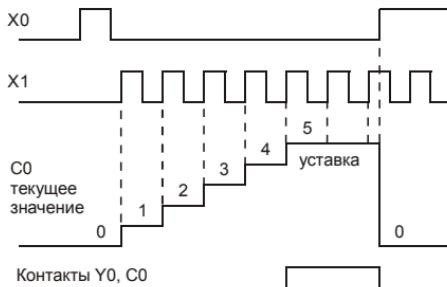
32-х битный высокоскоростной счетчик C235:
