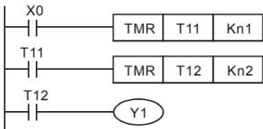
Выход  $Y_1$  будет включен через время  $n_1+n_2$  после замыкания контакта  $X_0$ .
