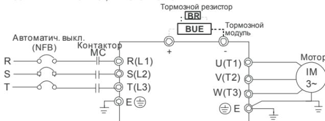
**Схема 2 (для типоразмеров В):** VFD007E11A, VFD015E21A, VFD022E21A/23A/43A
