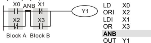
Команда ANB создает последовательную логическую связь между двумя логическими блоками (Block A и Block B).
