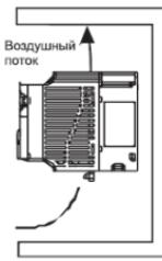
Типоразмер В, С и D. Установка с обеспечением допустимых зазоров.
