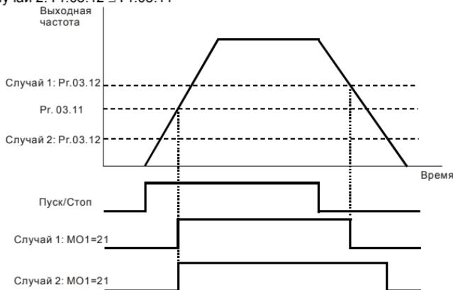
**03.13****Индикация состояния (вкл/выкл) дискретных выходов**
