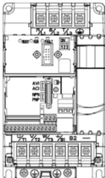
Силовые терминалы: R/L1, S/L2, T/L3, U/T1, V/T2, W/T3,  $\ominus$ , +/B1, B2, -
