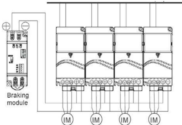
Для типоразмера А, клеммы «+» и «-» торм. модуля подключаются к клеммам «+» и «-» ПЧ.
