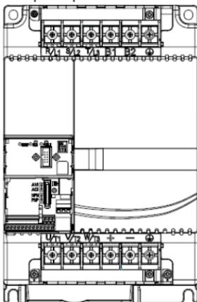
Силовые терминалы: R/L1, S/L2, T/L3, U/T1, V/T2, W/T3,
