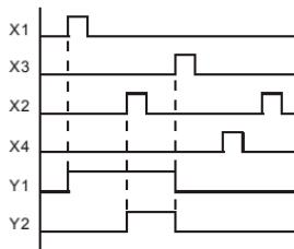
Контакты X1 и X3 включают/выключают выход Y1 автономно, а X2 и X4 могут управлять состоянием выхода Y1 только при условии, что Y1 включен, т.е. выход Y1 является последовательным контактом (логическим И) для нижней схемы.
