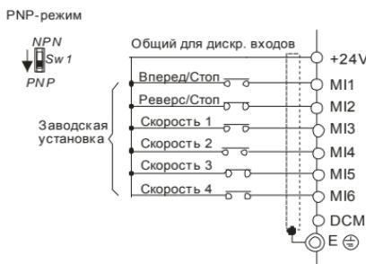
При положительной логике (PNP), сигнал считается поданным на данный вход, при втекании тока в него. Общим для дискретных входов, в этом случае, является терминал +24V.
