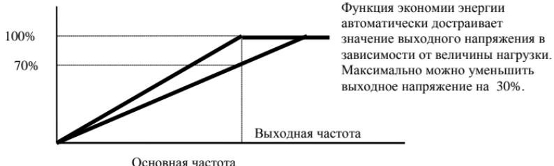
Функция экономии энергии автоматически достраивает значение выходного напряжения в зависимости от величины нагрузки. Максимально можно уменьшить выходное напряжение на 30%.
