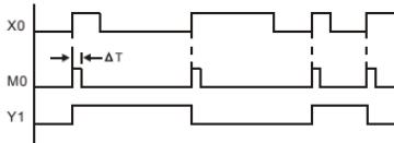
Каждое замыкание контакта X0 изменяет состояние выхода Y1 на противоположное. Эта схема еще называется импульсным реле.
