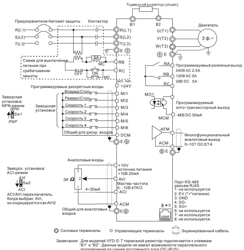
Замечание: Для моделей VFD-E-T тормозной резистор подключается к клеммам "B1" и "B2". Данные модели не имеют возможности параллельного подключения по шине постоянного тока (DC-BUS).
