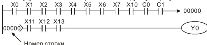
Сканирование программы начинается от левого верхнего угла схемы и заканчивается в правом нижнем углу. Следующий пример иллюстрирует последовательность выполнения программы:
