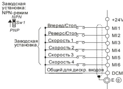
При отрицательной логике (NPN), сигнал считается поданным на данный вход, при вытекании тока из него. Общим для дискретных входов, в этом случае, является терминал DCM (0B).
