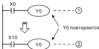
Состояние выхода Y0 будет определяться только контактом X10.
