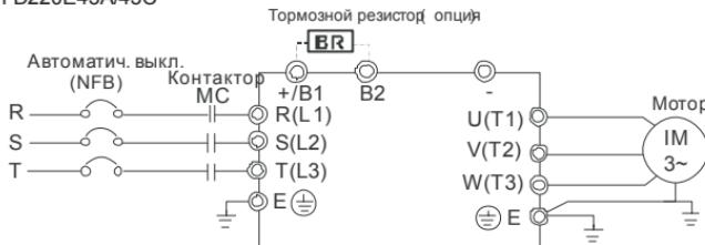
**Схема 3 (для VFD-E-T, типоразмер А):**
