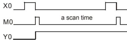
При изменении входного сигнала на входе X0 с "1" на "0" (спадающий фронт) реле M0 благодаря PLS-инструкции получает импульс (включается на время одного скана). С помощью этого импульса по контакту реле M0 включается выход Y0.
