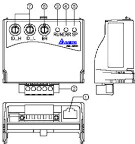
1. **RS-485 Interface (RJ45):** Порт связи VFD-E и CME-COP01.
