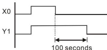
Когда X0 = 1, выход Y1 включен. При выключении X0, выход Y1 выключится через 100 секунд, т.к. операнд заданного значения таймера T0 имеет дискретность 0.1 сек, т.е. K1000 = 100 сек.
