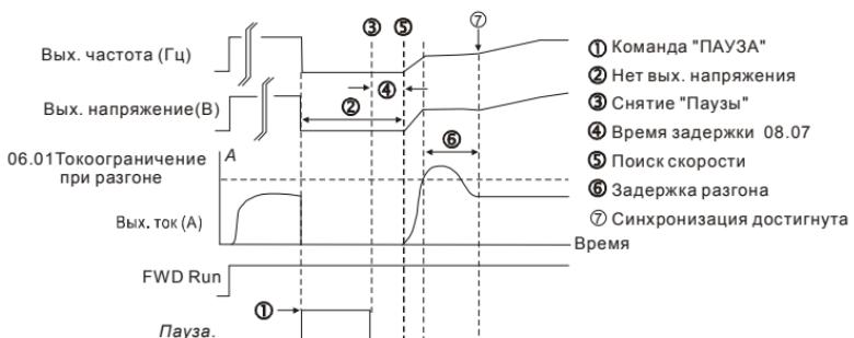
Рис 3: Поиск скорости с минимального значения частоты
