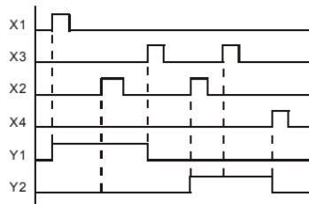
Схема исключает одновременное включение двух выходов. Когда включен один выход, второй будет заблокирован. При одновременном замыкании контактов X1 и X2 приоритет будет иметь Y1.
