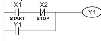
**Пример 3: самоблокировка выхода с использованием команд SET и RESET**
