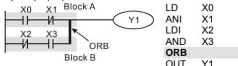
Команда ORB создает параллельную логическую связь между двумя логическими блоками (Block A и Block B).
