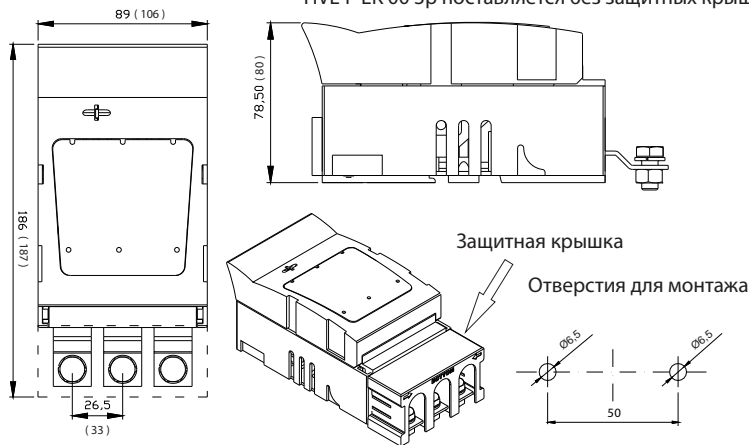
HVL-P EK 000 3p поставляется в комплекте с нижней защитной крышкой. HVL-P EK 00 3p поставляется без защитных крышек.
